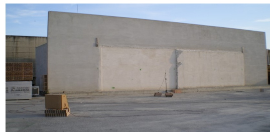
Sito sperimentale per prove di acustica edilizia in opera: sperimentazione dei livelli sonori, per la determinazione del potere fono isolante.
