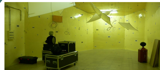
Sito sperimentale per prove di acustica edilizia in opera: sperimentazione dei livelli sonori, per la determinazione del potere fono isolante.
